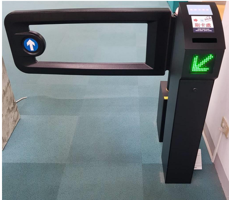
圖 6 蘭潭圖書館入口刷卡門柱及門桿
